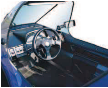
Das Cockpit des CityEL bietet viel Beinfreiheit. Das übersichtliche Armaturenbrett informiert über Geschwindigkeit und Ladezustand des Akkus.
